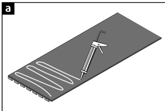
À l'aide d'un pistolet de distribution, distribuez le kit de montage sur le support en feutre du panneau.
