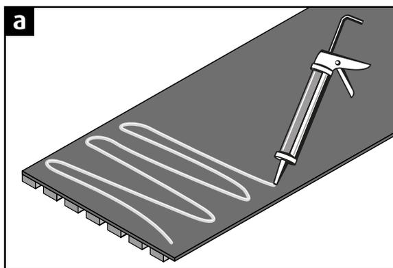
À l'aide d'un pistolet à calfeutrer, appliquez le kit de montage sur le support en feutre du panneau.
